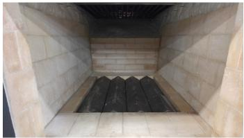
Le Tsunami est composé d'une chambre de combustion isolée avec des panneaux de laine de céramique isolante; les parois du foyer sont faites de briques réfractaires et son plancher est fait de grilles de fonte qui permettent à l'air des ventilateurs de circuler.
