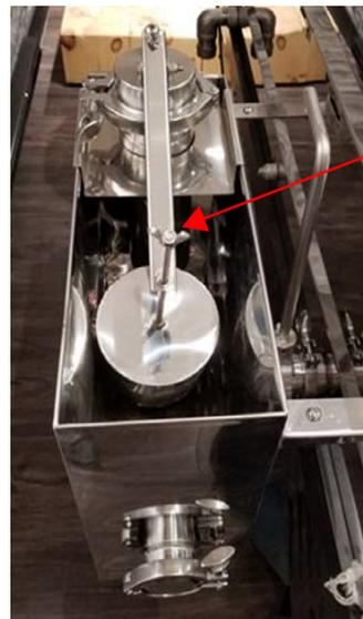
7. Pendant la saison, il est important de nettoyer fréquemment les joints toriques, brides et férules car les dépôts de sucres peuvent affecter l'étanchéité et les connections. Utiliser de la graisse alimentaire pour chacun des composants en contact avec la sève ou le sirop.
