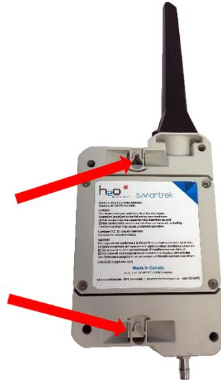
Figure 17 : Supports intégrés au boîtier
