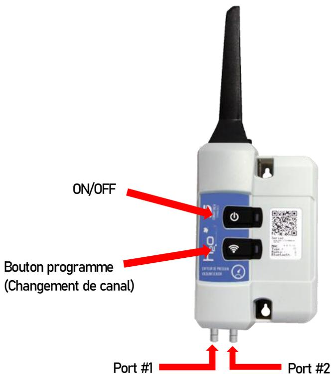
Figure 11 : Capteur de vacuum double
