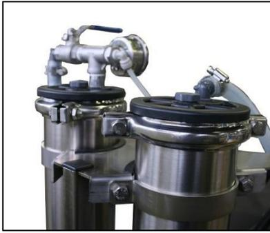
6. Insérer les bouchons dans le haut des récipients et les fixer avec les colliers. Le bouchon avec la valve V2 et le manomètre seront placés sur le récipient n° 2 d'un système à deux membranes (sur le récipient unique d'un système à une membrane).
