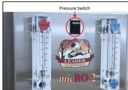
1. Placer le pressostat (situé au centre du panneau de commande) en position START (descente).
