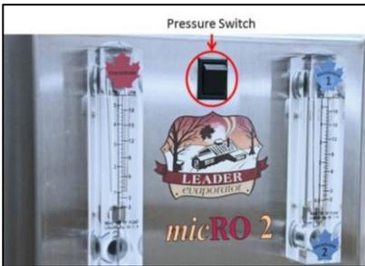
3. Placer le pressostat (situé au centre du panneau de commande) en position START (descente).
