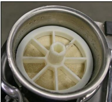
4. Insérer une membrane dans le récipient n° 1 (récipient n° 1 s'il s'agit d'un système à membrane unique). L'extrémité munie du joint entrera en dernier dans la cuve et le joint sera en haut de la cuve lorsqu'il sera en place. Soyez prudent lors de l'installation de la membrane - assurez-vous que le joint reste dans les rainures de la membrane lorsqu'elle pénètre dans la cuve. Si nécessaire, lubrifier le joint avec du perméat ou de l'eau de puits ou de source non chlorée.
