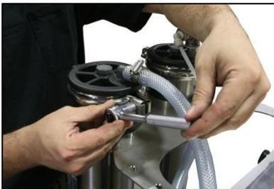
1. Retirer les colliers de fixation des couvercles de cuve en retirant les boulons de chaque côté du collier.
