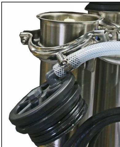
1. Inspecter les joints d'étanchéité des couvercles de cuve - en haut et en bas. Remplacer les joints s'ils sont endommagés ou si des fuites ont été constatées. Lubrifiez les joints avec du perméat ou de l'eau de puits ou de source non chlorée.
