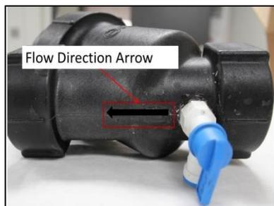
1. Identifier le sens d'écoulement à travers la crépine. Une flèche située sur le dessus de la crépine indique le sens de l'écoulement. Le côté entrée pousse le liquide à travers la crépine avant qu'il n'entre dans le système. En outre, lors du montage de la crépine, l'embout doit se trouver sur le dessus car il devra être ouvert pour purger l'air du système,
