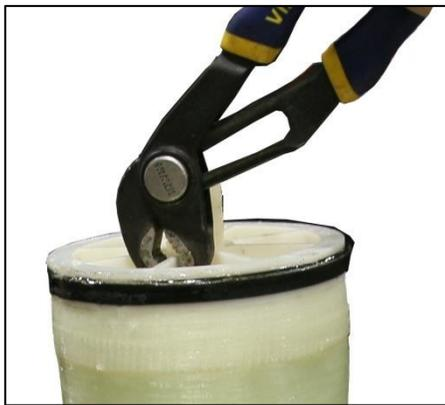
3. Saisir et soulever la membrane du récipient n° 2, dans le cas d'un système à deux membranes. Retirer la membrane du récipient unique dans le cas d'un système à une membrane. Il peut être nécessaire d'utiliser une aide mécanique (pince ou pince-étau) pour maintenir la membrane pendant le retrait. Si vous utilisez une aide mécanique, veillez à tirer par l'âme et NON par le centre.
