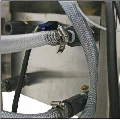
6. Positionner le(s) collier(s) de serrage en acier inoxydable sur le tuyau de l'adaptateur et serrer les colliers de serrage.
