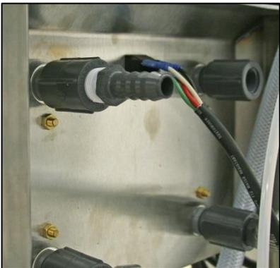
3. Couper un tuyau tressé de" de diamètre intérieur d'une longueur suffisante pour se connecter au connecteur de sortie du débitmètre de perméat vers le réservoir de perméat ou le réservoir de lavage, selon la longueur la plus importante.
