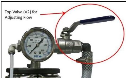
7. Régler le débit souhaité à l'aide de la vanne située sur la partie supérieure de la membrane latérale droite.
