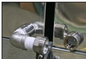
5. Vissez l'assemblage en acier inoxydable avec l'extrémité femelle sur le bac arrière. Serrez de sorte que l'extrémité femelle soit orientée vers le bac avant et que l'assemblage soit parallèle au fond du bac. REMARQUE : Si l'assemblage ne peut pas être serré dans cette position, retirez-le et ajustez la quantité de ruban de Téflon autour des filets.
