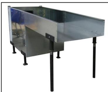
5. Insérez les jambes dans les supports de jambe pour maintenir l'arrière du plateau en place.
