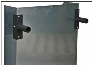
3. Fixez un support de jambe de chaque côté du plateau inférieur. Les trous fournis se trouvent à l'arrière du plateau. Utilisez des boulons et écrous  $\frac{1}{4}$  X 20 X  $\frac{3}{4}$ ". Serrez les fixations.
