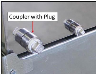
1. Retirez le bouchon fileté du raccord situé sur le côté de vidange (avant) de la marmite à ébullition avant. Si vous utilisez une marmite standard Half Pint comme marmite avant, le raccord sera soit à droite, soit à gauche. Si vous utilisez une marmite Supreme comme marmite avant, le raccord sera à gauche.
