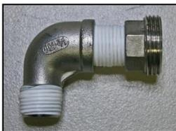
3. Vissez le côté femelle de l'union en acier inoxydable ½" sur un des ensembles de raccord coudé en acier inoxydable ½".
