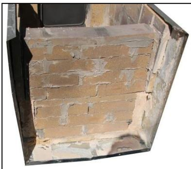
6. Pour faciliter l'attachement et l'assemblage du kit d'extension, retirez la rangée de briques sur les côtés et le sol derrière le pare-feu de l'Arche Half Pint.
