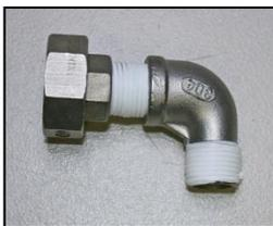
4. Vissez le côté mâle de l'union en acier inoxydable ½" sur l'autre ensemble de raccord coudé en acier inoxydable ½".
