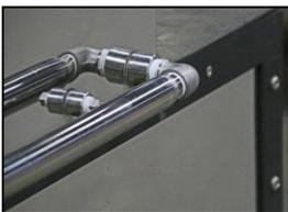
7. Vissez l'extrémité filetée exposée du tuyau en acier inoxydable de ½ pouce par 30 pouces dans le coude de rue en acier inoxydable arrière. NOTE : il peut être nécessaire de séparer légèrement les deux poêles pour effectuer cette étape.
