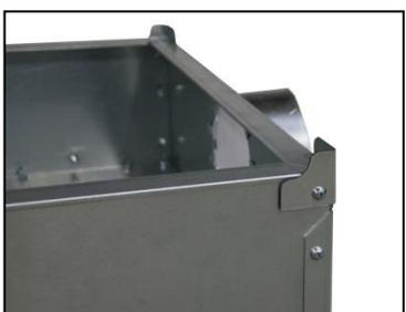
10. Montez une équerre d'angle de chaque côté de l'arche. La courbure de l'équerre doit être orientée vers l'avant. Fixez les équerres avec des boulons  $\frac{1}{4}$  - 20 X  $\frac{3}{4}$ " et les écrous correspondants. Serrez les fixations à la main.
