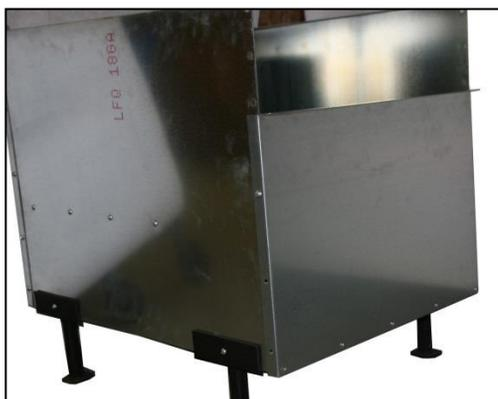
1. Montez le panneau inférieur à l'arrière de l'arche. Les rebords du panneau inférieur seront à l'extérieur du sol et des panneaux latéraux de l'arche. Fixez le panneau arrière avec des boulons ¼ - 20 X ¾" et des écrous correspondants. Serrez les fixations à la main.
