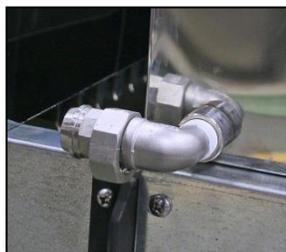
6. Vissez l'assemblage en acier inoxydable avec l'extrémité mâle sur le bac avant. Serrez de sorte que l'extrémité mâle soit orientée vers le bac arrière et que l'assemblage soit parallèle au fond du bac. Il sera nécessaire de séparer les deux bacs pour tourner l'assemblage. REMARQUE : Si l'assemblage ne peut pas être serré dans la position requise, retirez-le et ajustez la quantité de ruban de Téflon autour des filets.
