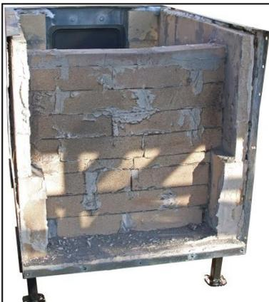
5. Enlevez les briques contre l'arrière de l'arche Half Pint. Ensuite, retirez les boulons et écrous qui fixent l'arrière de l'arche au sol et aux côtés de l'arche. Retirez l'arrière.
