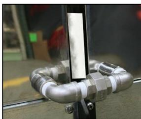
7. Coupez un joint de bac de 4" X 36" (Numéro de commande LEADER : 65162) pour s'adapter entre les bacs avant et arrière. Alignez les parties femelle et mâle de l'union et serrez ensemble.
