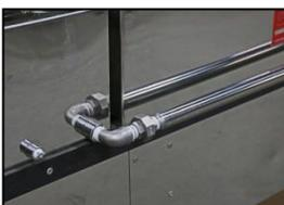
8. Alignez les deux moitiés de l'union (une sur la poêle avant et l'autre sur le tuyau de la poêle arrière) et serrez. NOTE : les poêles peuvent nécessiter d'être déplacées légèrement pour aligner les moitiés de l'union.
