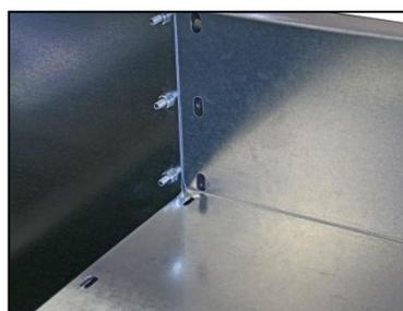
6. Placez un boulon  $\frac{1}{4}$  - 20 X  $\frac{3}{4}$ " à travers chaque trou (3 au total de chaque côté) pour fixer le côté du plateau au côté de l'arche. Vissez les écrous correspondants puis serrez à la main.
