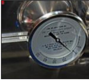
6. Installez un thermomètre (non fourni) du côté de la vidange de la casserole de cuisson avant. Le thermomètre est monté dans un raccord fileté de ¼" près du coupleur de la vanne de vidange. Retirez le bouchon du raccord dans la casserole. Enroulez du ruban Téflon sur les filetages du thermomètre et vissez-le dans le raccord. Serrez et tournez le "7" pour qu'il soit bien droit pour une lecture plus facile à côté de l'évaporateur.
