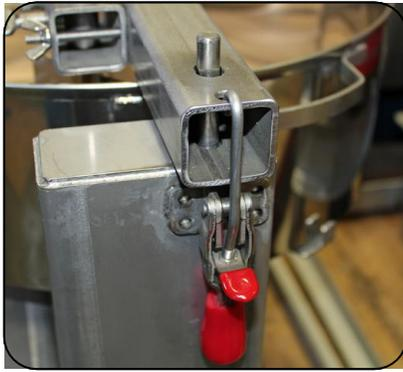
3. Les extrémités de la barre de pales comportent deux trous. Insérez les pales dans leurs supports respectifs. Le haut de la tige de la pale doit être du même côté que le haut de la barre de pales.
