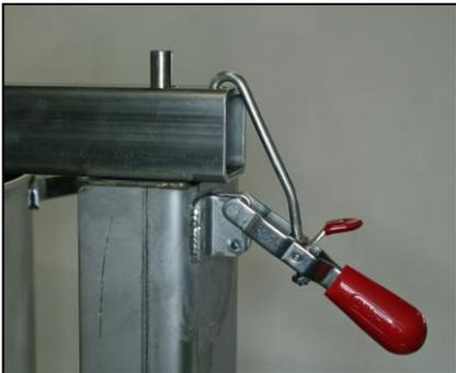
4. Positionnez les pales à environ 1,25 cm du bas de la barre de pales, puis serrez la vis de serrage pour maintenir les pales en place. Placez la barre de pales sur les goupilles de base. Verrouillez la barre de pales à l'aide des verrous à enclenchement insérés dans les trous extérieurs en haut de la barre de pales..
