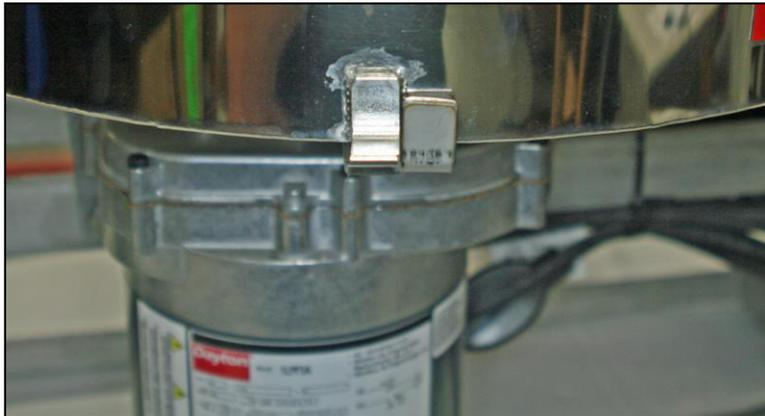
6. Placez la cuve avec le sirop refroidi sur la base de la machine à crème. Alignez la cuve avec le support. Le moteur tourne dans le sens des aiguilles d'une montre, alors alignez les languettes de la cuve sur le côté gauche des languettes du support. Cela évitera le glissement et l'usure lorsque le moteur démarre.
