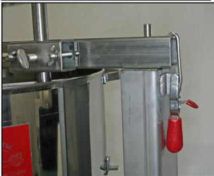
5. Installez la pale extérieure (celle avec la projection vers le bas). La fente du support pour la pale extérieure (dans la barre de pales) est celle qui s'ouvre le plus vers l'extérieur pour la cuve.
