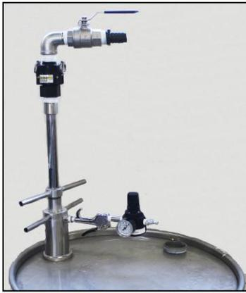
6. Ouvrez les verrous du connecteur rapide B et positionnez-le sur le connecteur rapide au sommet de l'arbre de la pompe. Verrouillez les connecteurs rapides ensemble.
