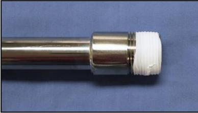
1. Enroulez du ruban téflon autour des filetages du raccord au sommet de l'arbre de la pompe.
