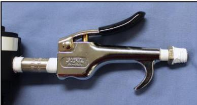
3. Appliquez du ruban téflon sur l'extrémité fileté exposée de l'ensemble régulateur.
