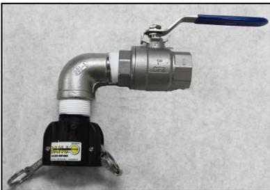
7. Vissez une vanne à bille en acier inoxydable de 1" sur les filets enroulés de téflon du coude en acier inoxydable de 1" et serrez.
