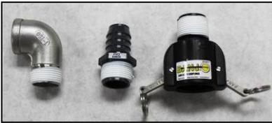
5. Enroulez du ruban en téflon sur les filets d'un coude en acier inoxydable de 1", d'un adaptateur en PVC de 1" et d'un raccord rapide style B de 1".
