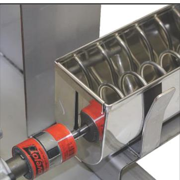
6. Placez la porte coulissante à l'intérieur de l'extrémité du bac où l'arbre de la vis est coupé. Faites glisser la porte jusqu'à ce qu'elle soit en place sur le bord du bac.
