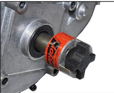
3. Insérez le raccord à quatre voies dans le couplage sur l'arbre moteur. Les doigts de l'araignée entourent les projections du coupleur.
