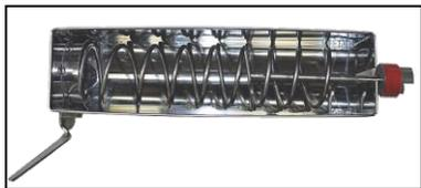
4. Placez la vis dans le bac de manière à ce que l'extrémité spirale de la vis soit à l'extrémité du robinet du bac. L'extrémité du coupleur glissera dans la fente à l'autre extrémité du bac.
