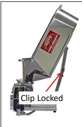
10. Relevez lentement la plateforme et le « cochon » jusqu'à ce que la charnière se verrouille. NOTE : Il y aura du poids et possiblement des surfaces chaudes selon le produit et la quantité traitée.
