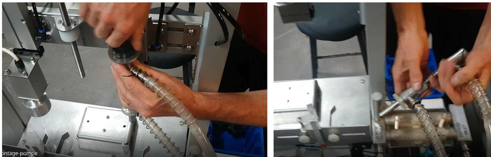
*Démonter la buse de remplissage*
