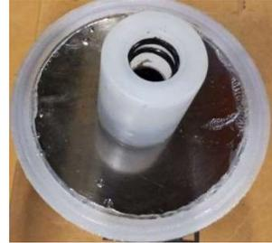
Repositionner le couvercle du caisson, remettre les férules en place.
