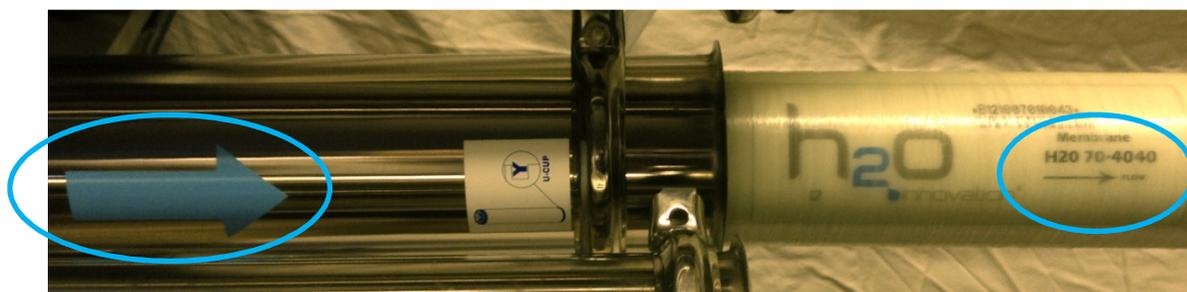
Le lubrifiant empêchera l'assèchement des U-Cup, mais facilitera aussi l'insertion de la membrane dans le caisson. Pousser ensuite fermement la membrane dans le récipient en tournant afin de bien l'emboîter.
