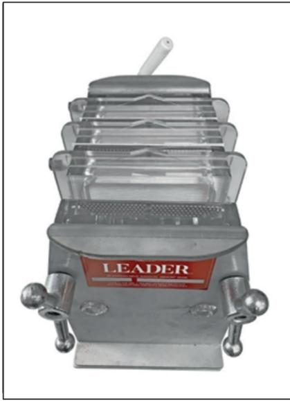
Glissez le dernier cadre, correctement aligné, sur le support contre le papier filtre et la grille de tamisage en veillant à maintenir le papier filtre en place.
