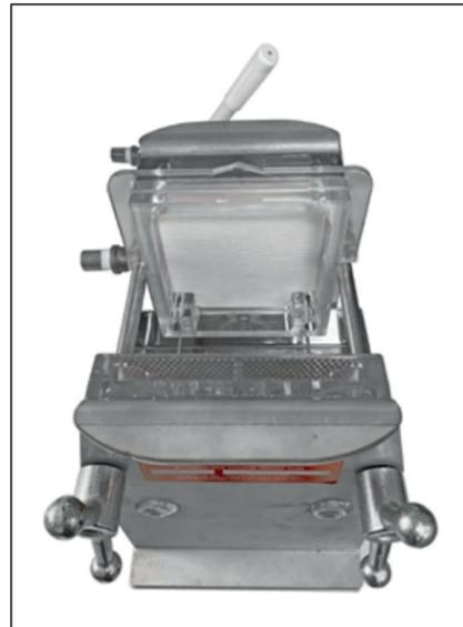
Placez un morceau de papier-filtre sur la plaque d'entrée. Alignez les trous du papier sur ceux de la plaque de base.
