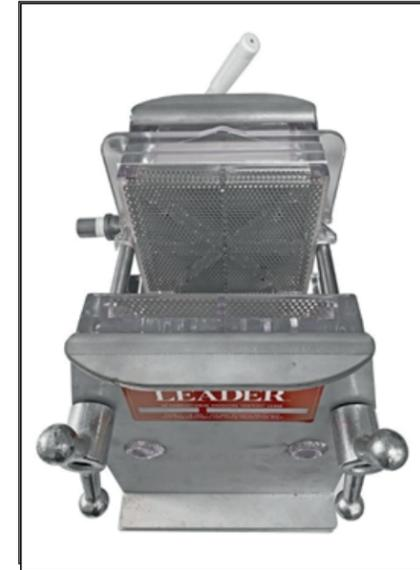
Glissez une grille de tamisage, correctement alignée (côtés avec crochets à gauche et côtés plats à droite), sur le support contre le papier filtre et le cadre en veillant à maintenir le papier filtre en place.
